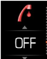
Das Programm erwärmt das Wasser auf 65 °C, um die mögliche Bakterie Legionella zu entfernen. Einschalten kann automatisch oder manuell erfolgen.
