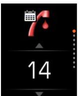
Die Überhitzung (*Kapitel 8.3.11*) kann so eingestellt werden, dass sie nach dem Dienstplan im Betrieb ist. Automatische Überhitzung ist serienmäßig auf periodische Wiederholung jede 14 Tage eingestellt (Einstellungen ermöglichen eine Periode von 1-99 Tage). Falls wir die automatische Überhitzung nicht wünschen, wird die Periode auf **OFF** eingestellt.
