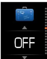
Das Programm URLAUB ermöglicht, die Anlage für eine bestimmte Anzahl der Tage auszuschalten, wenn Sie wissen, dass es kein Bedarf nach Warmwasser besteht. In dieser Zeit wird kein Programm ausgeführt, auch wenn es nach dem Dienstplan eingestellt ist. Wenn das eingestellte Zeitintervall abgelaufen ist, geht die Anlage automatisch in das grundlegende Betriebsprogramm zurück.
