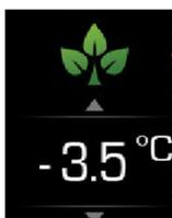
Im Betriebsprogramm EKO Anlage erwärmt das Wasser auf die eingestellte Temperatur mit berücksichtigter negativer Differenz. Die gewünschte Temperaturdifferenz wird mit der Taste **▲** oder **▼** ausgewählt. Die Einstellung wird mit der Taste **OK** bestätigt.
