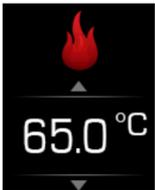
Bei Benutzung einer externen Quelle wird die max. Temperatur eingestellt, bis der die externe Quelle das Wasser erwärmen kann. Die Standby-Temperatur ist bei alternativer Betriebsweise auf einen Fixwert von 10 °C eingestellt.
