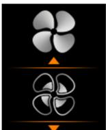
Auf der Anlage ist es möglich 2 verschiedene Ventilator-Geschwindigkeiten einzustellen; normale und erhöhte Geschwindigkeit. Einstellung der Geschwindigkeit hängt von der Art des Einbaus der Anlage und Montage der Luftkanäle ab. Falls es sich um Montage ohne Luftkanäle handelt, wird die Einstellung einer niedrigen Ventilator-Geschwindigkeit empfohlen. Die Ventilatorgeschwindigkeit ist serienmäßig auf niedrige Geschwindigkeit eingestellt.
