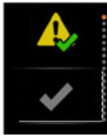
Bei einem oder mehreren Fehlern auf der Anlage wird im Menü die neue Einstellung »Bestätigung der Fehler« angezeigt. Bei Fehlerbestätigung wird die Anlage erneut in den Betrieb genommen und es wird überprüft, ob die Ursache für den Fehler gehoben wurde. Falls der Fehler gehoben wurde, ist die Einstellung »Fehlerbestätigung« im Menü nicht mehr sichtbar.
