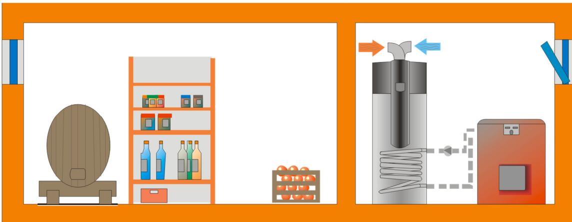
**Abbildung 2: Ansaugen aus dem Raum - Ausblasen in den selben oder einen entfernten Raum**
