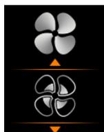
Nell'impianto è possibile scegliere tra 2 diverse velocità di ventilazione: velocità normale o elevata. L'impostazione della velocità dipende dal tipo di struttura dell'impianto e dall'installazione dei condotti dell'aria. In caso di installazione senza condotti dell'aria, si consiglia di optare per una velocità ridotta del ventilatore. La velocità dei ventilatori di default è impostato sulla velocità bassa.
