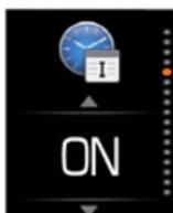
La modifica del programma di funzionamento può essere effettuata automaticamente mediante la programmazione giornaliera. Per ogni programmazione giornaliera si possono impostare fino a due intervalli temporali. Per ogni intervallo è possibile impostare l'orario di inizio, l'orario di fine e il programma di funzionamento dell'impianto. Negli orari che non rientrano nell'intervallo impostato, l'impianto riprende il funzionamento secondo il programma di base.
