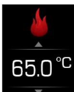
Quando si utilizza una sorgente esterna, è necessario impostare la temperatura max, ossia il valore da raggiungere prima che la sorgente esterna interrompa il riscaldamento dell'acqua. Nell'ambito della modalità di funzionamento alternativa, la temperatura/stand-by ha un valore fisso pari a 10°C.
