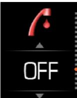
Il programma riscalda l'acqua fino a 65°C per eliminare i possibili batteri di legionella. L'attivazione può avvenire manualmente o in automatico.
