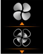
Nell'impianto è possibile scegliere tra 2 diverse velocità di ventilazione: velocità normale o elevata. L'impostazione della velocità dipende dal tipo di struttura dell'impianto e dall'installazione dei condotti dell'aria. In caso di installazione senza condotti dell'aria, si consiglia di optare per una velocità ridotta del ventilatore. La velocità del ventilatore di default è impostato sulla velocità bassa.
