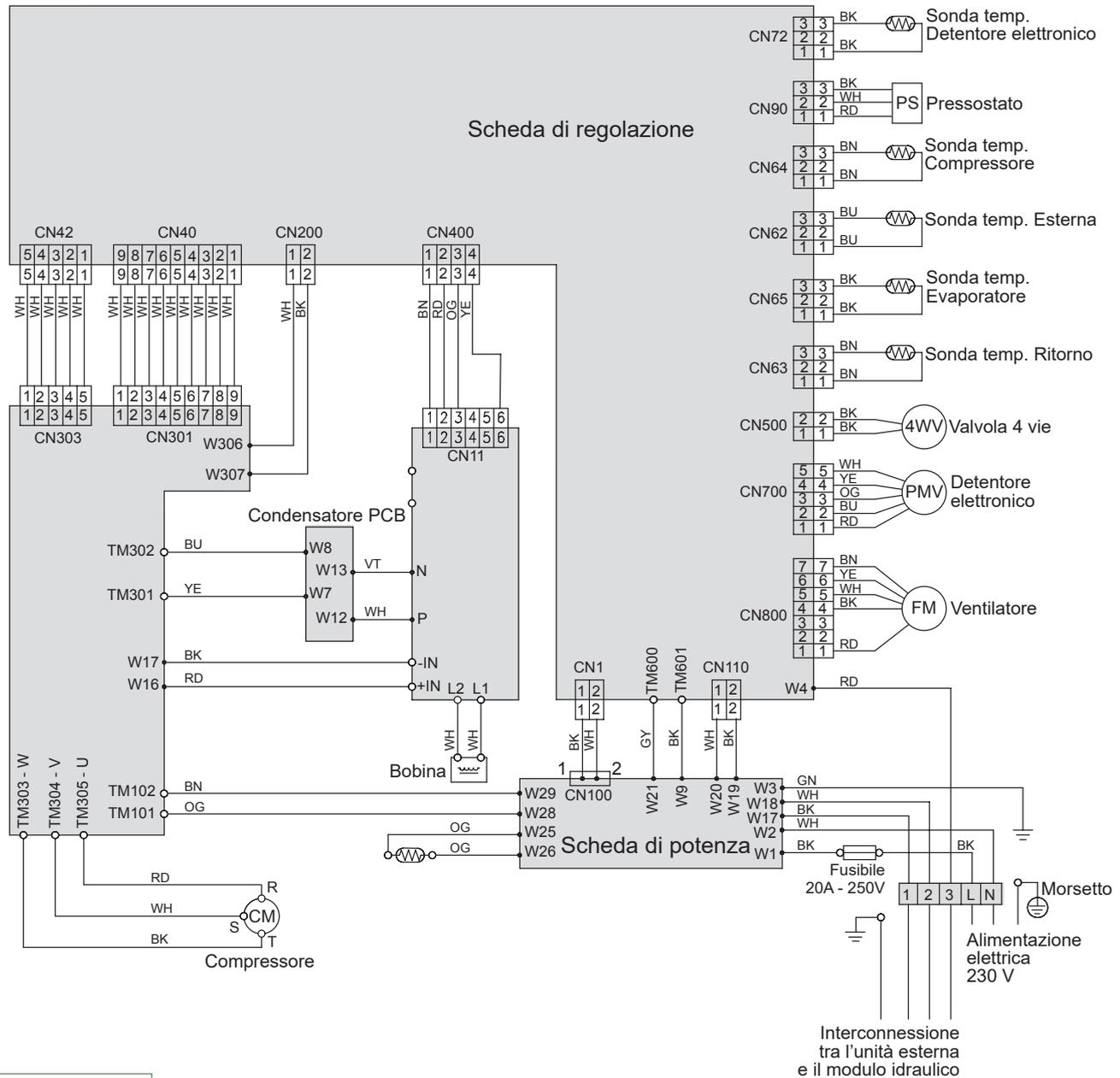
fig. 43 - Cablaggio elettrico unità esterna modello Alfa Extensa A.I. 10
