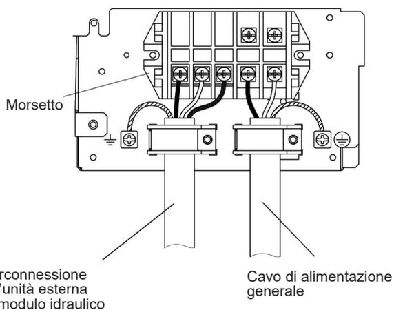
fig. 30 - Connessioni al morsetto dell'unità esterna
