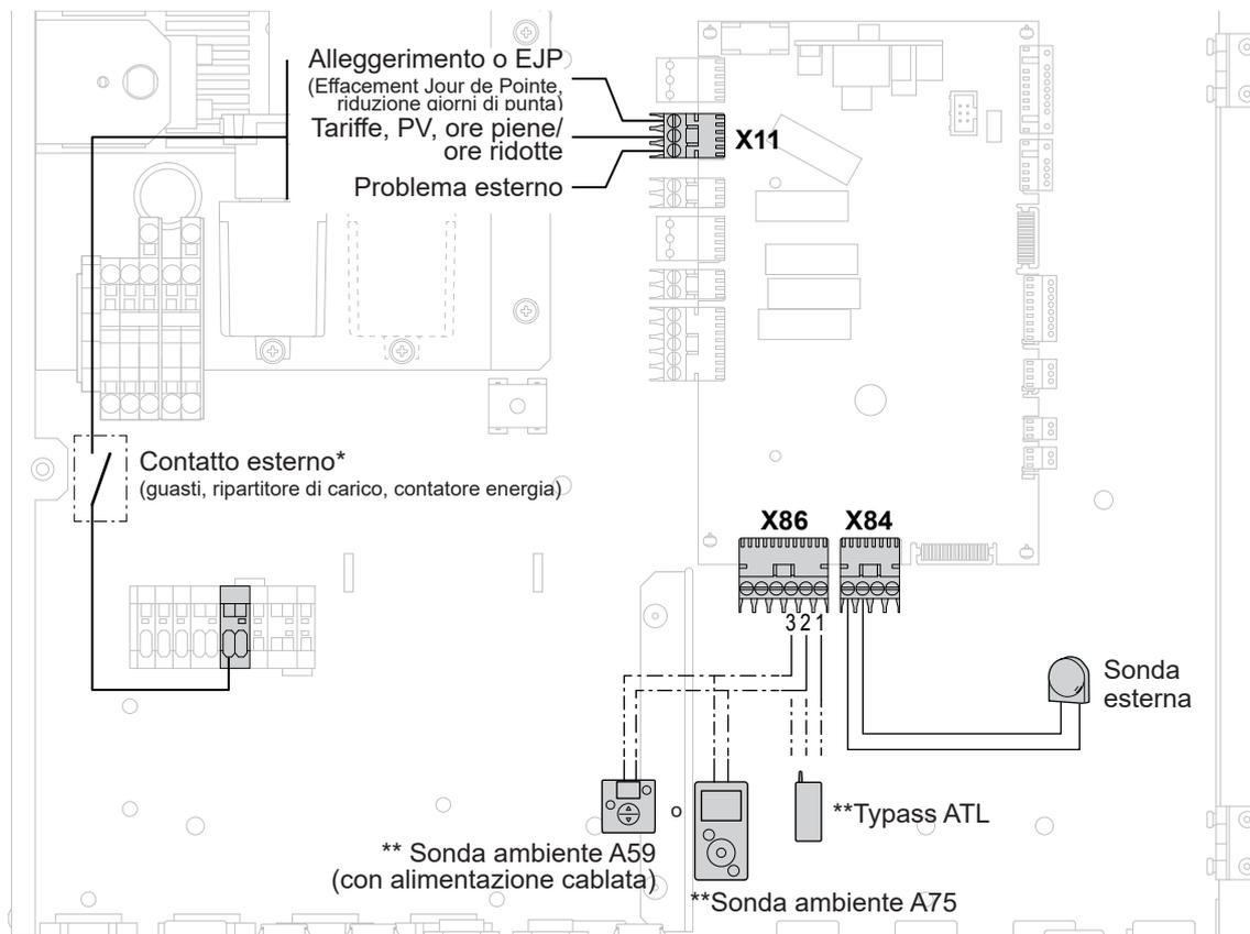
\*Se il dispositivo di comando non ha un contatto libero da potenziale, bisognerà ritrasmettere il contatto per ottenere un cablaggio equivalente. In tutti i casi, riferirsi alle istruzioni degli organi esterni (ripartitore di carico, contatore energia) per realizzare il cablaggio.
