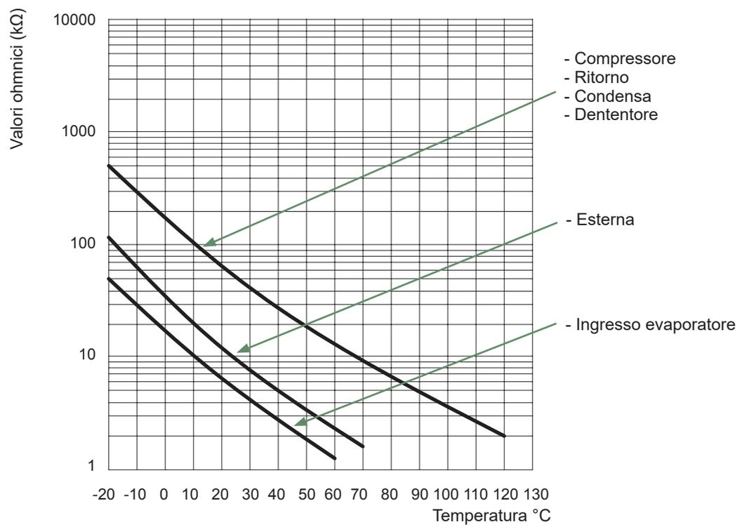
fig. 7 - Valori ohmici delle sonde (Unità esterna)
