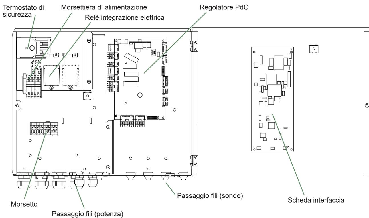
fig. 33 - Descrizione del quadro elettrico del modulo idraulico
