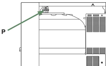
fig. 25 - Spurgo automatico del modulo idraulico
