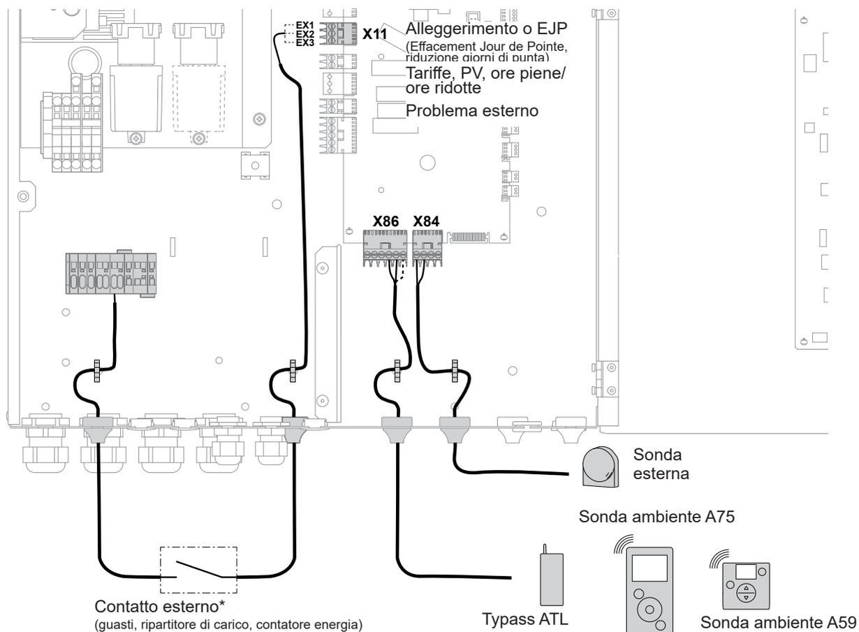
fig. 34 - Passaggio dei cavi delle sonde
