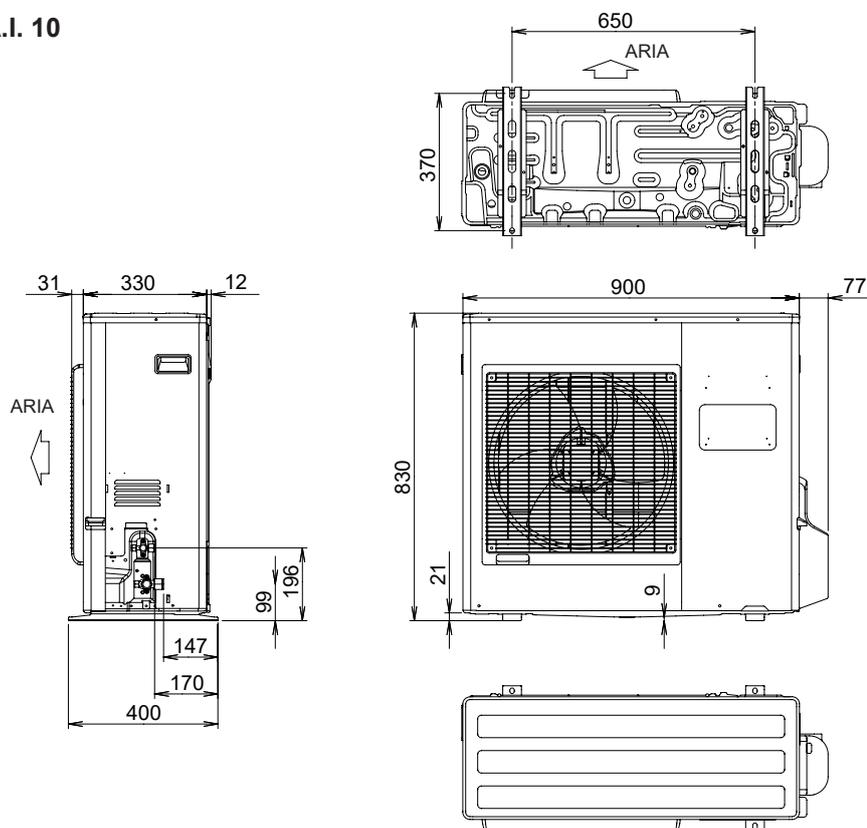
fig. 1 - Dimensioni in mm
