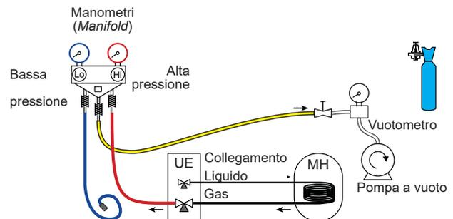
b) Interrompere la pompa a vuoto, chiudere la valvola all'uscita del flessibile di servizio (giallo), collegare questo flessibile al detettore di pressione della bombola di azoto, iniettare 2 bar, richiudere la valvola del flessibile.
