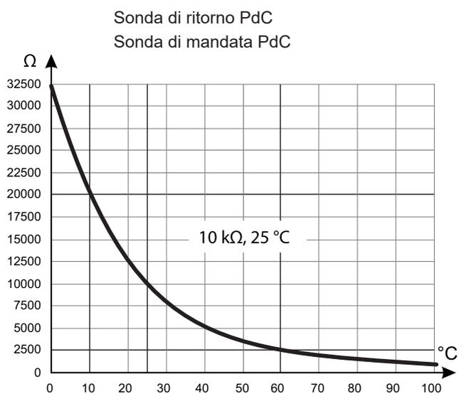
fig. 6 - Valori ohmici delle sonde (Modulo idraulico)
