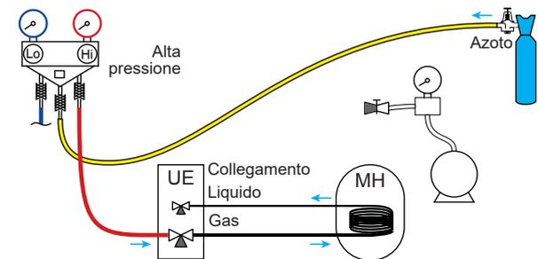
c) Collegare di nuovo il flessibile alla pompa a vuoto, metterla in funzione e aprire lentamente la valvola del flessibile.
