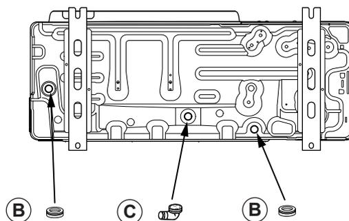
fig. 14 - Posa dell'unità esterna, uscita della condensa
