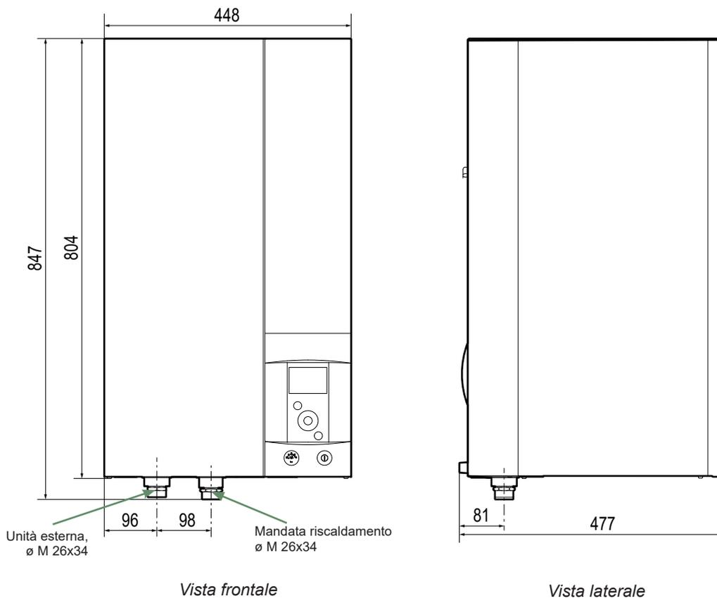
Ingombro del modulo idraulico, cfr. [pagina 22](#).
