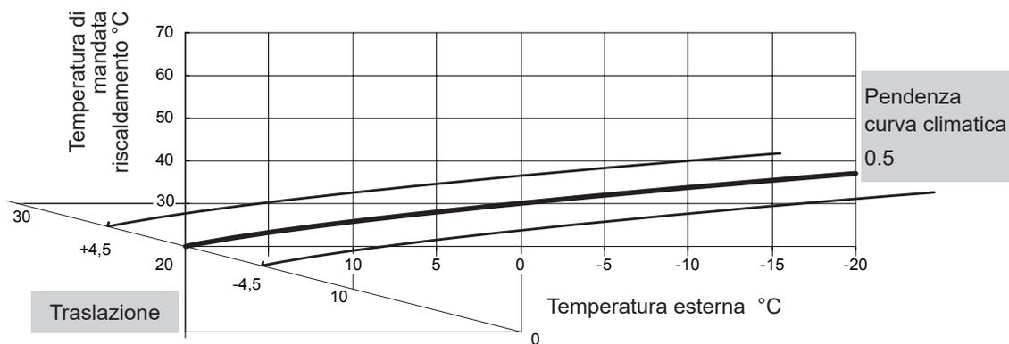
fig. 39 - Traslazione della curva di riscaldamento
