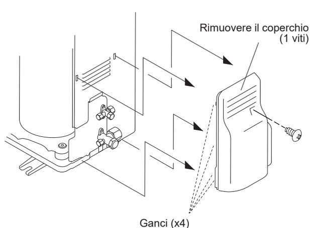
fig. 31 - Accesso al morsetto dell'unità esterna
