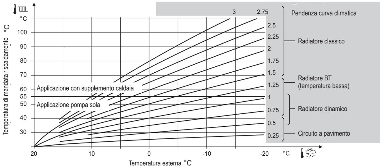
fig. 38 - Pendenza della curva di riscaldamento
