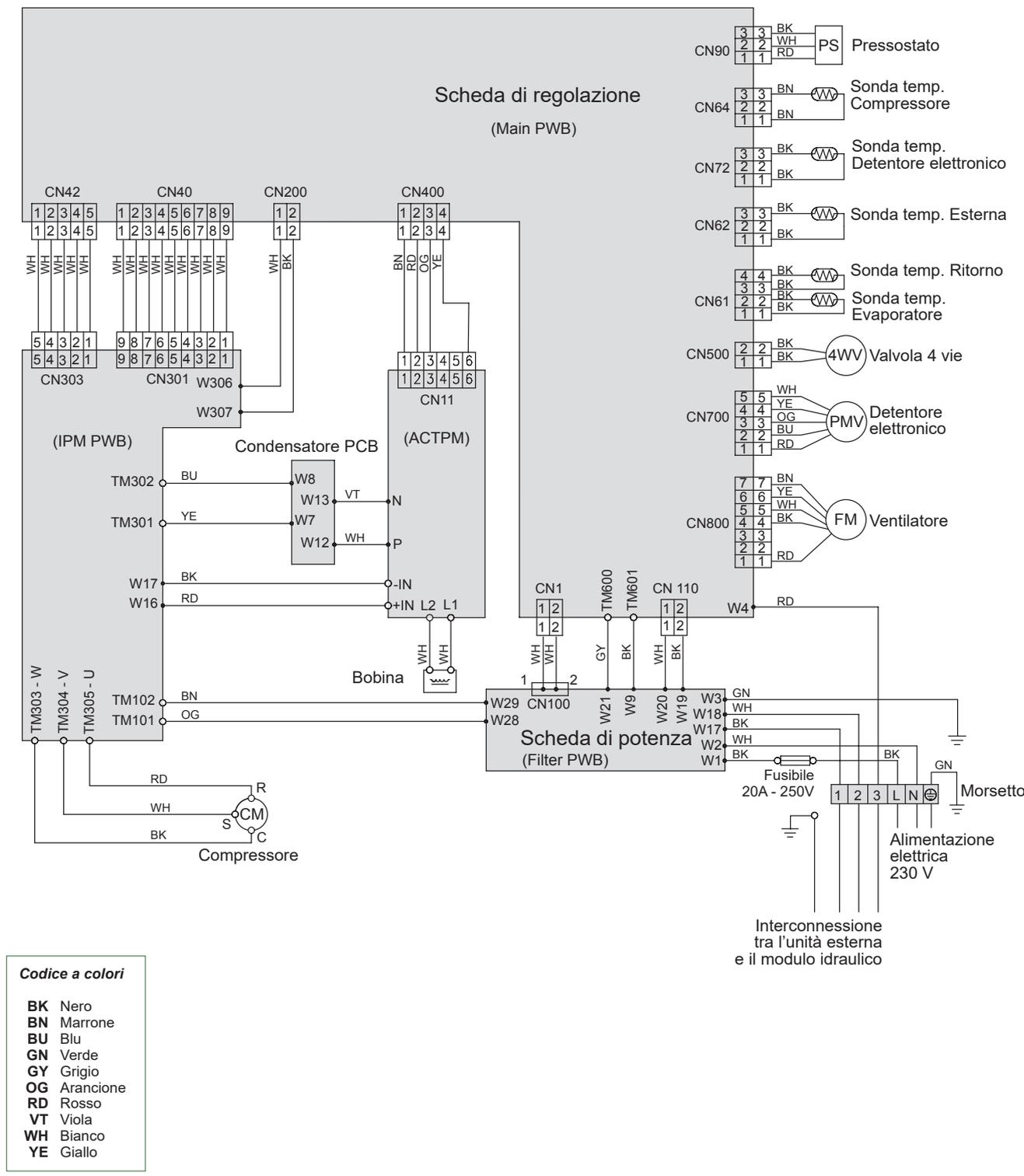
fig. 42 - Cablaggio elettrico unità esterna modello Alféa Extensa A.I. 8
