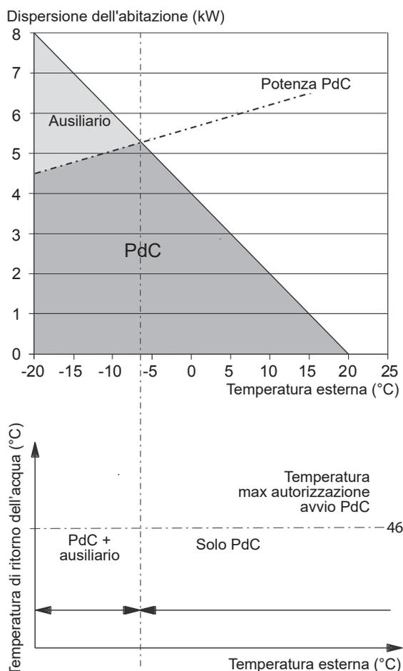
fig. 10 - Esempio e limiti di funzionamento
