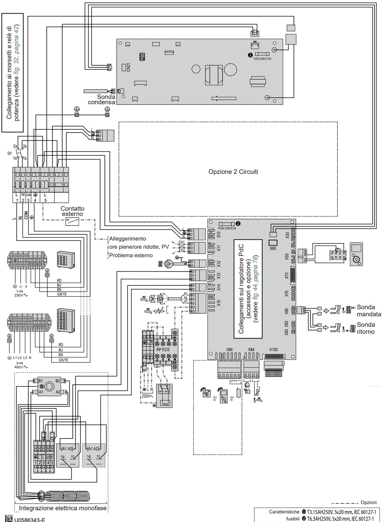
fig. 44 - Cablaggio elettrico modulo idraulico (fuori collegamenti installatore)
