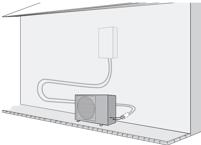
*fig. 12 - Suggerimento per la disposizione dei collegamenti frigoriferi*
