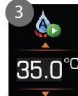
3 Temperatureinstellung, bei der das Programm »Schnelle Erwärmung des Sanitärwassers« ausgelöst wird.
