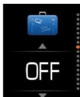
Das Programm URLAUB ermöglicht, die Anlage für eine bestimmte Anzahl der Tage auszuschalten, wenn Sie wissen, dass es kein Bedarf nach Warmwasser besteht. In dieser Zeit wird kein Programm ausgeführt, auch wenn es nach dem Dienstplan eingestellt ist. Wenn das eingestellte Zeitintervall abgelaufen ist, geht die Anlage automatisch in das grundlegende Betriebsprogramm zurück.
