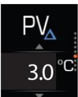
Wenn die Temperatur des Sanitärwassers im Programm PV (*Kapitel 9.3.4*) unter dem eingestellten Wert des Programms PV für den Wert der Temperaturabweichung sinkt (»Standby im Programm PHOTOVOLTAIK«), beginnt die Anlage mit erneuter Erwärmung des Sanitärwassers.
