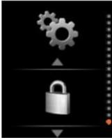
Das Menü ermöglicht den Zugang zu den fortschrittlichen Einstellungen der Steuervorrichtung mittels Eintragung des 4-stelligen PIN Codes.
