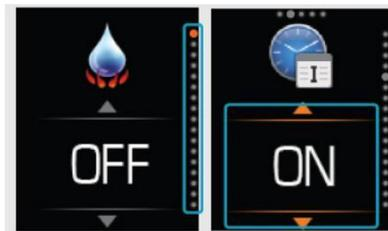
Orange Indikatoren zeigen die momentane Auswahl auf der Steuervorrichtung.
