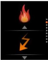
Mit der Funktion **zusätzliche Quelle** (*Kapitel 9.1.2*) wird eine oder eine Kombination mehrerer Heizquellen eingeschaltet; die Auswahl hängt vom Typ der Wärmepumpe und Vorhandensein der Heizquellen im Heizsystem ab:
