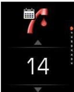
Die Überhitzung (*Kapitel 8.3.11*) kann so eingestellt werden, dass sie nach dem Dienstplan im Betrieb ist. Automatische Überhitzung ist serienmäßig auf periodische Wiederholung jede 14 Tage eingestellt (Einstellungen ermöglichen eine Periode von 1-99 Tage).
