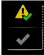
Bei einem oder mehreren Fehlern auf der Anlage wird im Menü die neue Einstellung »Bestätigung der Fehler« angezeigt. Bei Fehlerbestätigung wird die Anlage erneut in den Betrieb genommen und es wird überprüft, ob die Ursache für den Fehler gehoben wurde. Falls der Fehler gehoben wurde, ist die Einstellung »Fehlerbestätigung« im Menü nicht mehr sichtbar.
