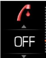
Das Programm erwärmt das Wasser auf 65 °C, um die mögliche Bakterie Legionella zu entfernen. Einschalten kann automatisch oder manuell erfolgen.
