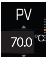
Die Anlage im Programm PHOTOVOLTAIK - PV (Solar-Photovoltaiksystem, siehe *Kapitel 9.3.4*) erwärmt das Sanitärwasser bis zur eingestellten Temperatur des Programms PV. Serienmäßige Temperatureinstellung beträgt 70 °C.
