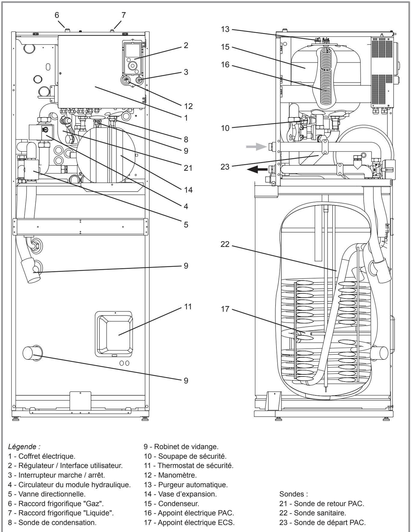
figure 9 - Organes du module hydraulique
