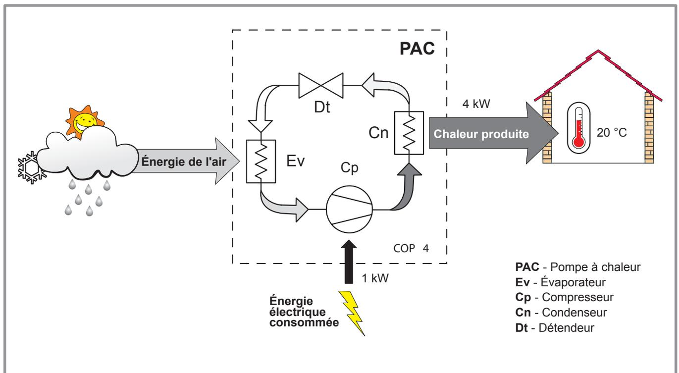
figure 11 - Principe de fonctionnement d'une pompe à chaleur
