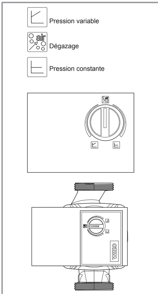
figure 32 - Bouton de réglage du circulateur
