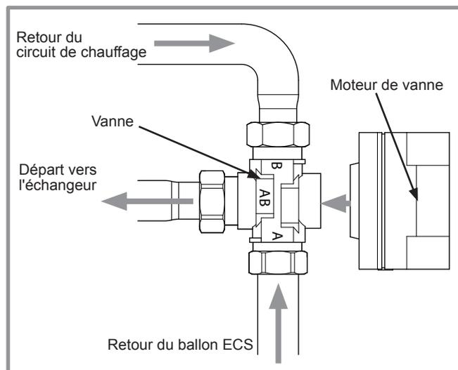
figure 50 - Montage de la vanne directionnelle
