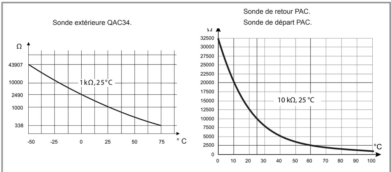
figure 6 - Valeur ohmique des sondes (Module hydraulique)
