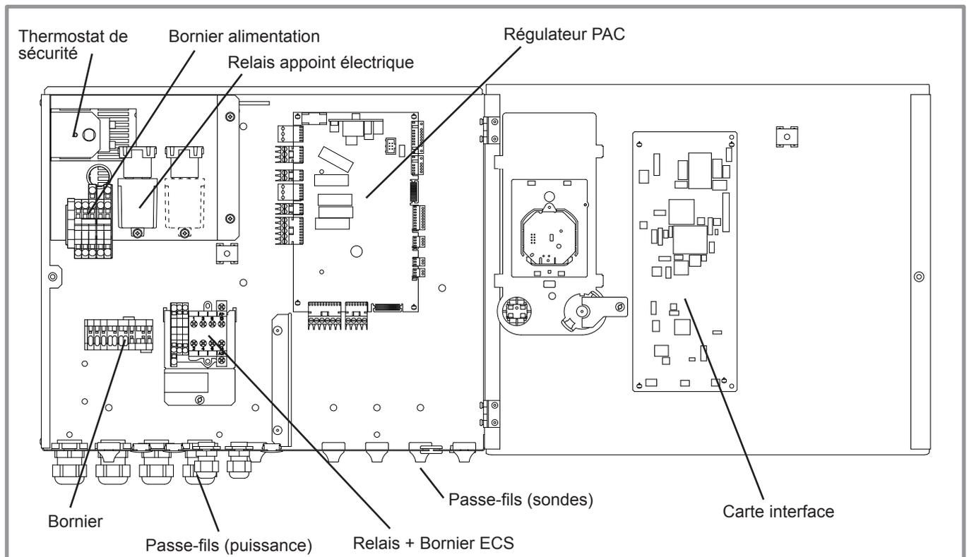
figure 36 - Descriptif du coffret électrique du module hydraulique
