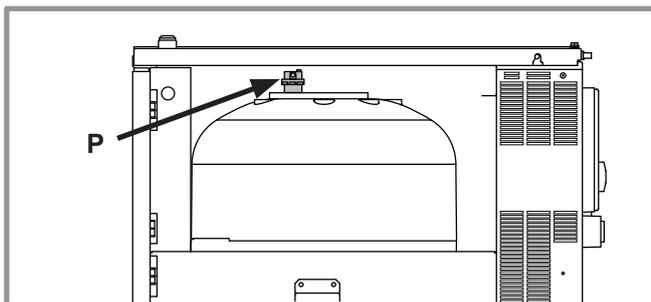
figure 29 - Purgeur automatique du module hydraulique
