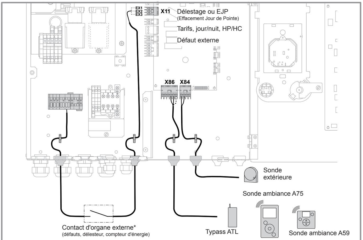
figure 39 - Passage des câbles des sondes
