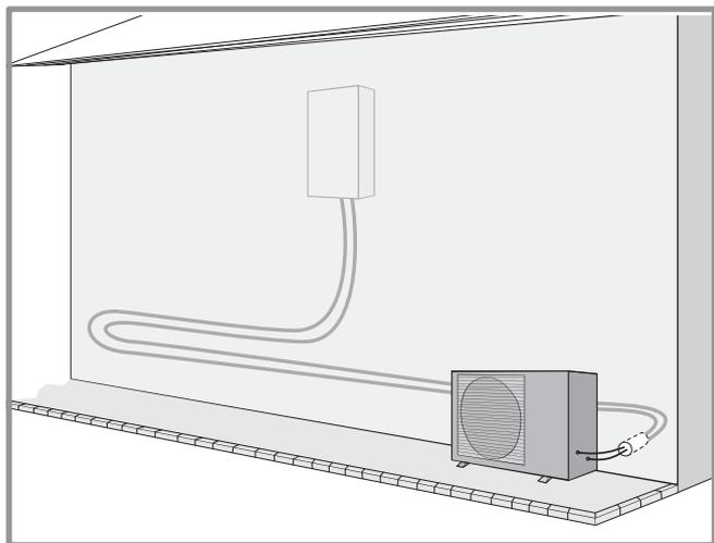
*figure 12 - Exemple conseillé de disposition des liaisons frigorifiques*
