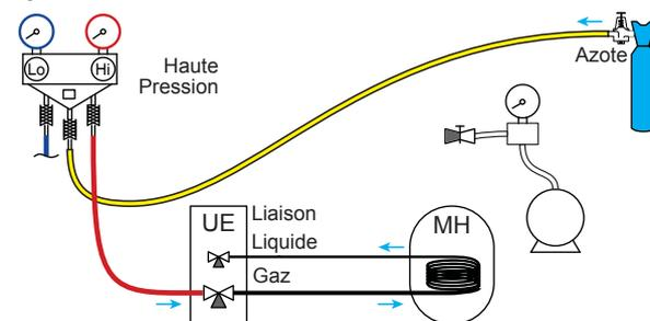
c) Raccorder à nouveau le flexible sur la pompe à vide, la mettre en fonction et ouvrir progressivement la vanne du flexible.
