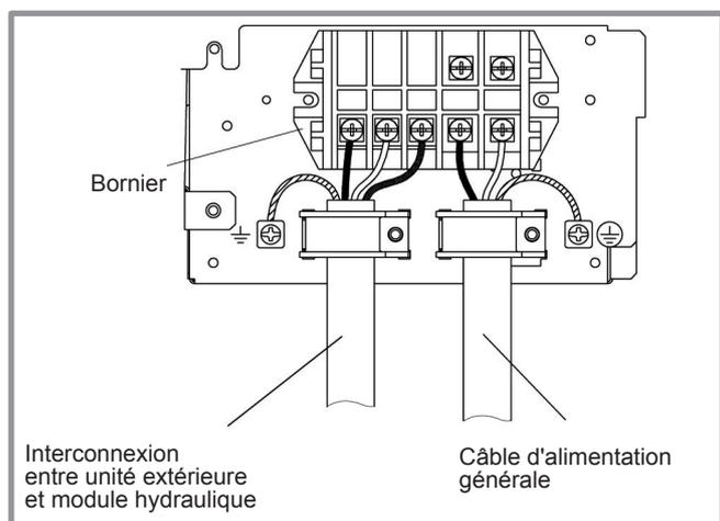
figure 34 - Connexions au bornier de l'unité extérieure
