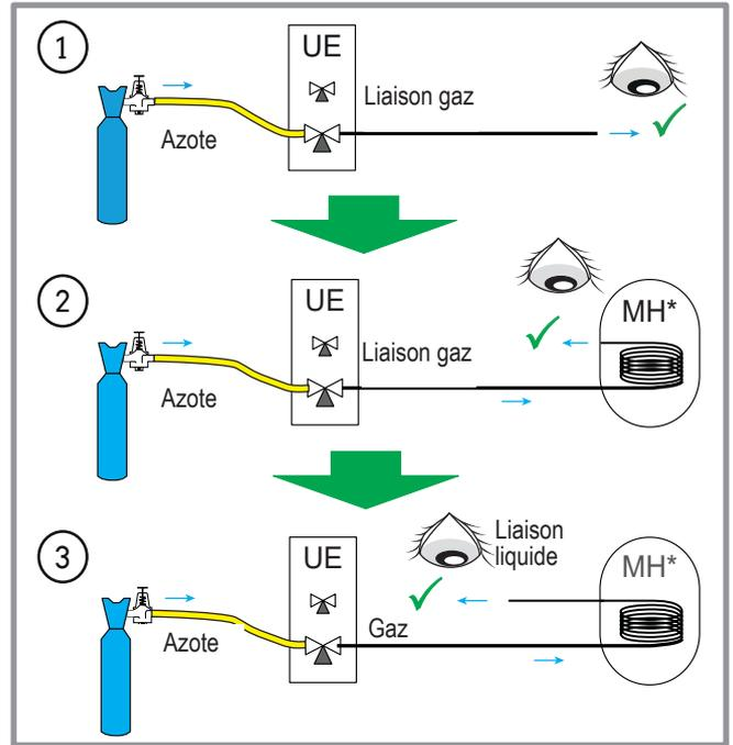
figure 21 - Vérification des liaisons frigorifiques
