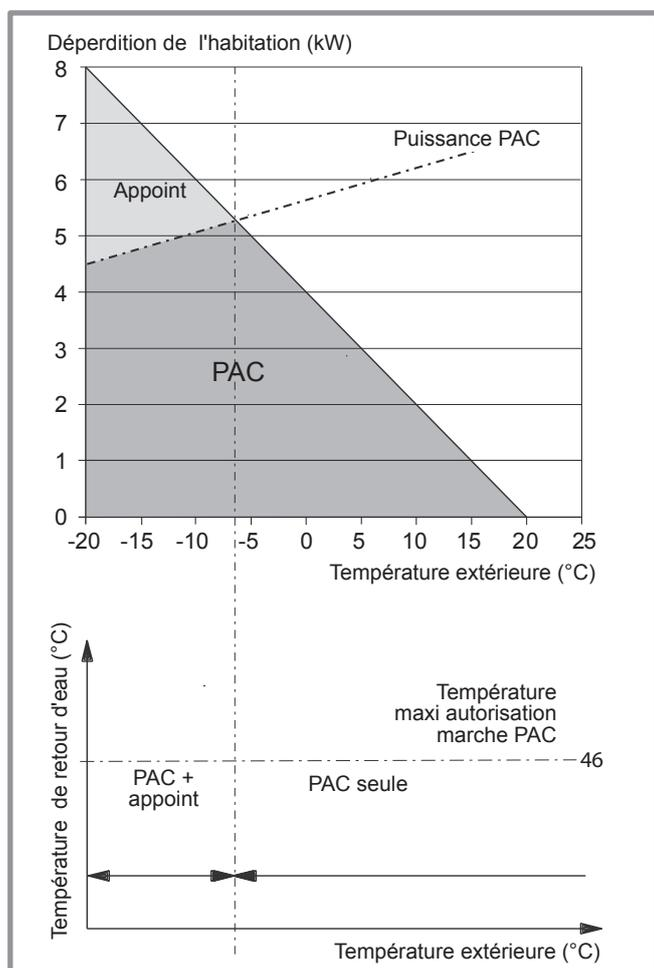
figure 10 - Exemple et limites de fonctionnement
